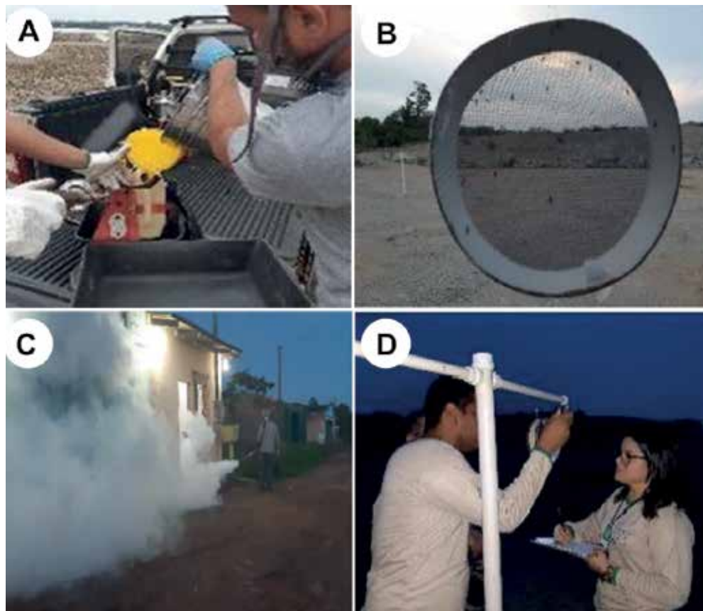
Figura 7.2. Teste de inseticidas de ação espacial. A) Preparação do termonebulizador, B) mosquitos em gaiolas expostas às partículas do inseticida, C) termonebulização de domicílio e D) avaliação do efeito inseticida sobre os mosquitos expostos à névoa de inseticida.
