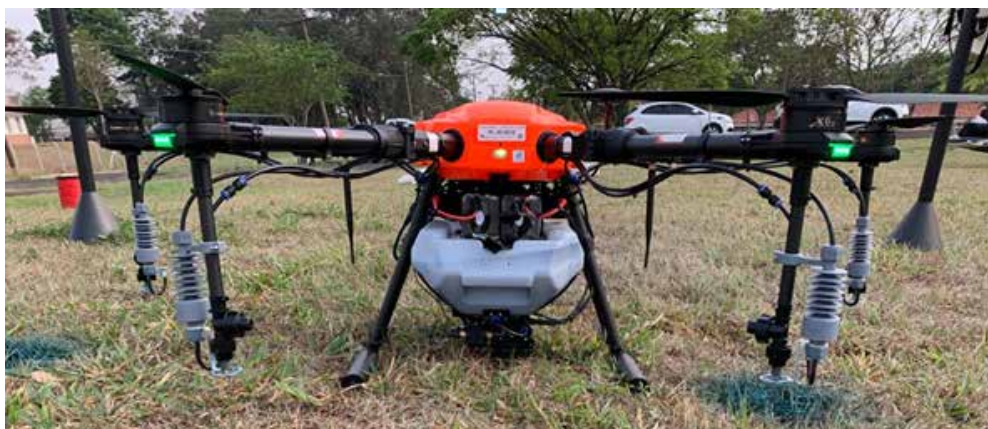
Figura 5.1: Drone pelicano 2020 hexacóptero com pulverização eletrostática (Porto Alegre, 2020).
