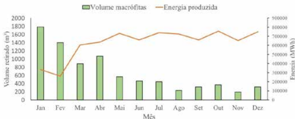
Figura 1.4 - Variação mensal dos volumes de macrófitas retiradas das grades das turbinas e produção de energia na UHE Souza Dias, Castilho, SP. Adaptado de Mustafá et al. (2010).
