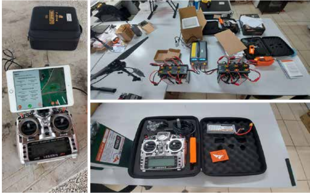
Figura 5.2: Controle de comandos, hub de comunicação e hub de carregamento de baterias de lítio (Porto Alegre, 2020).
