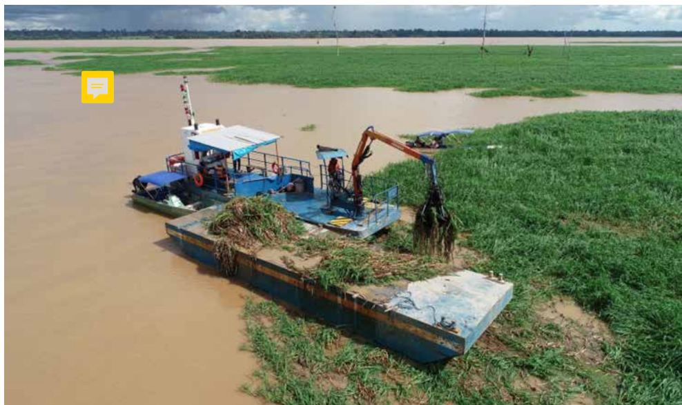
Figura 3.5: Embarcação multifuncional desenvolvida com recursos do projeto de pesquisa, operando no controle de plantas aquáticas no Igarapé São Domingos.
